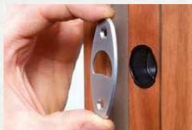
Após inserir o dedal plástico de acabamento, fixar o chapa testa em correspondência com parte superior do furo.
