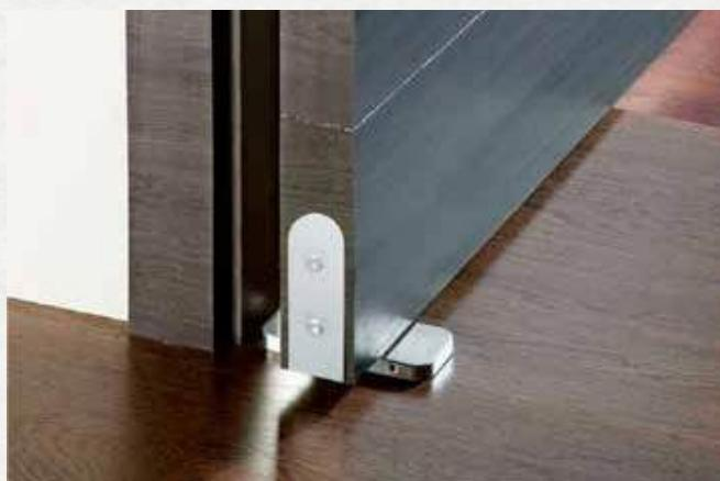
SELF MOTION é uma dobradiça pivô com mola hidráulica para portas de madeira e alumínio. O sistema de auto fechamento é integrado na parte interna da porta. A grande vantagem é que não há necessidade de fazer nenhum corte no piso, facilitando a instalação e proporcionando uma considerável redução do tempo de montagem. Espessura mínima da porta 40 mm.
